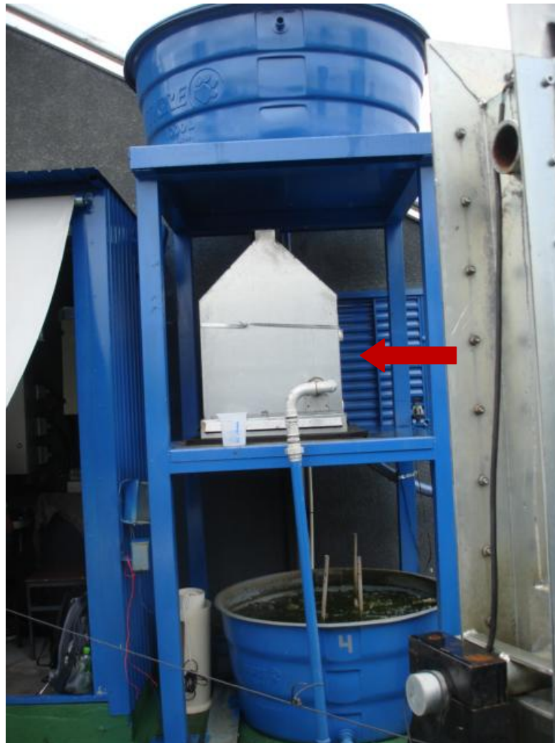
Figura 15 – Localização do motor da bomba do sistema.
