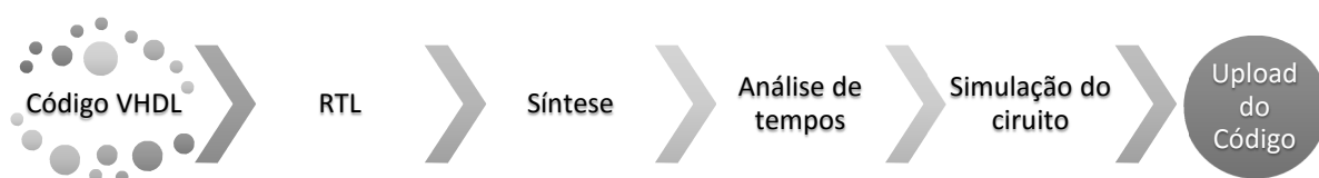
Figura 15 - Etapas de codificação e implementação de um circuito em FPGA.
