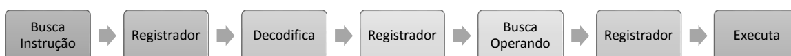
Figura 9 - Modelo de execução de um pipeline linear Adaptado: De Rose e Navaux (2008).
