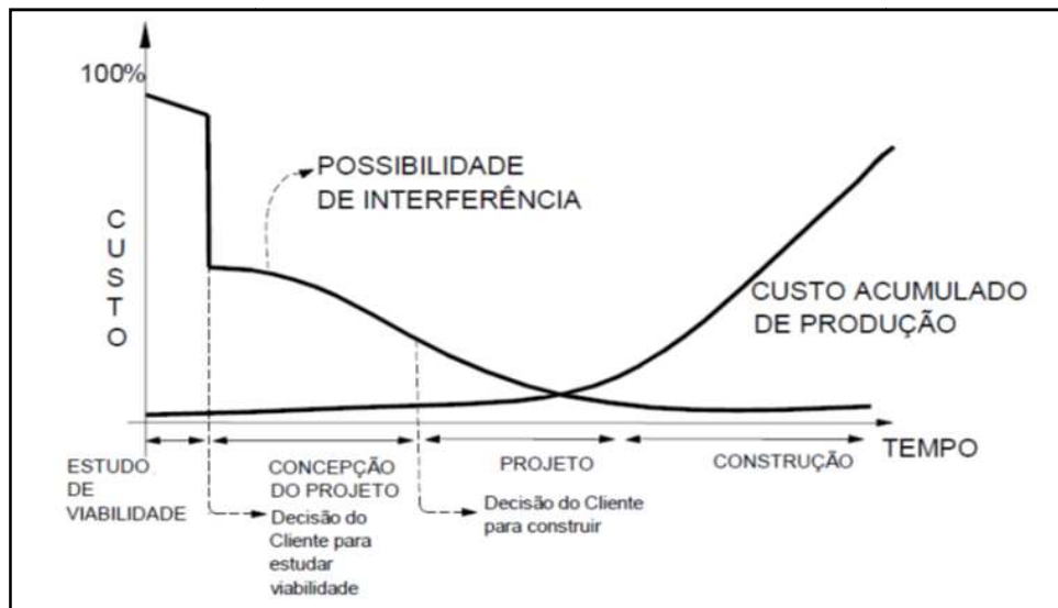
Gráfico 2 -Redução de custos e de falhas na construção. Fonte: Hammarlund e Josephson (1992, apud Peralta, 2002).
