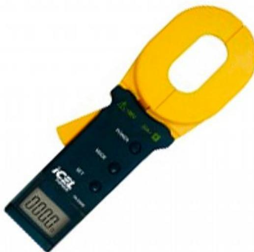
Figura 05: Alicate Terrômetro utilizado.
