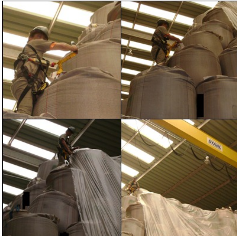
Figura 19: Sequência da escalada nas sacarias e operação de ponte rolante. Fonte: O Autor (2014).
