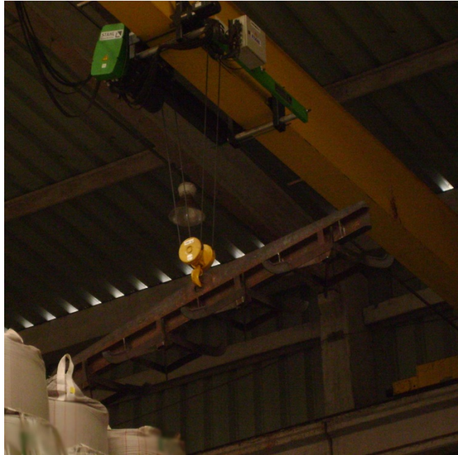
Figura 20: Ponte Rolante – Dispositivo para carregar sacarias. Fonte: O Autor (2014).
