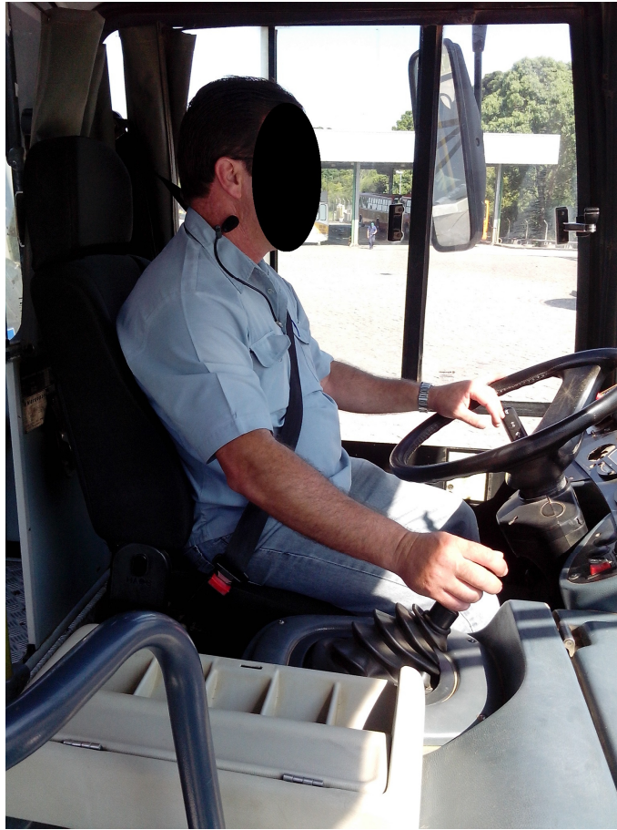
Figura 14 - Posição do microfone durante medição de ruído Fonte: O Autor (2014)
