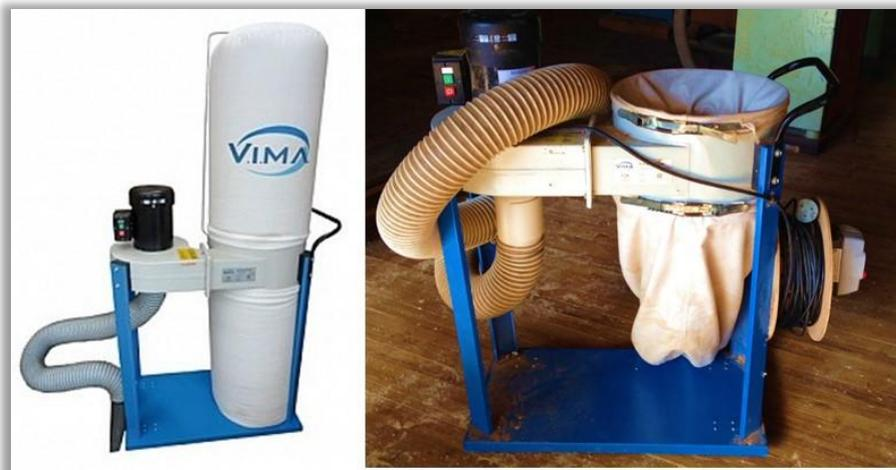
Figura 17. Coletor de pó utilizado na empresa: Forma do coletor em funcionamento (esquerda), adaptação de extensão elétrica no coletor feita pela empresa para circulação com o mesmo (direita).
