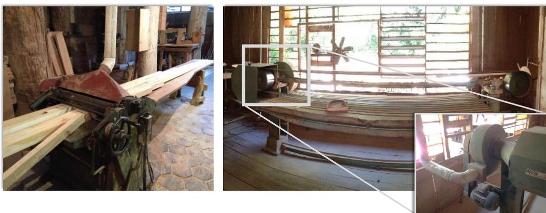
Figura 14. Máquinas com captação de poeira: plaina desengrossadeira (esquerda) e lixadeira (direita)
