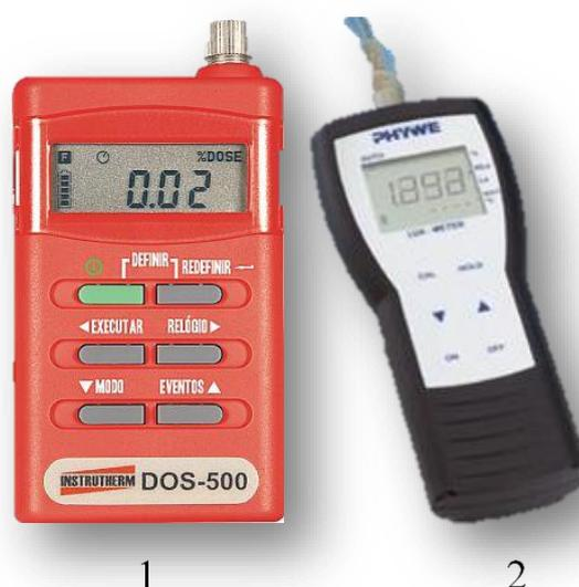
Figura 9. Aparelhos utilizados nas medições (1) Dosímetro de ruído e (2) Luxímetro
