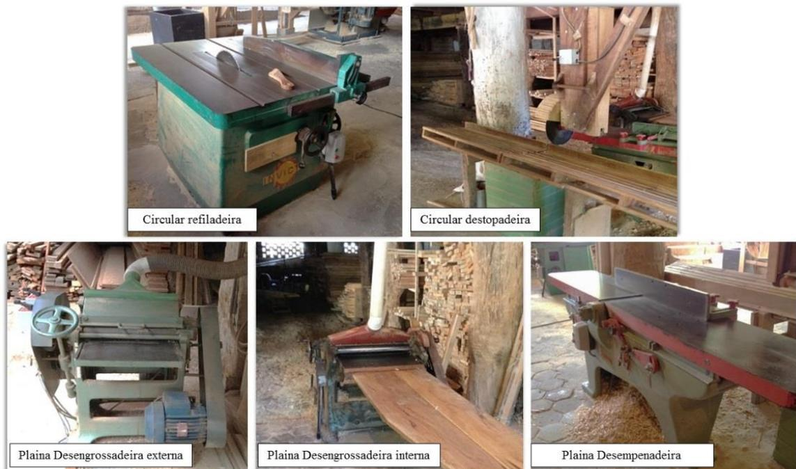
Figura 20. Máquinas da área B avaliadas individualmente com base na NR-12 e 18
