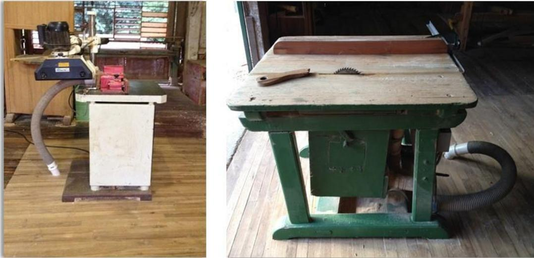
Figura 15. Máquinas com captação de serragem: tupa (esquerda) e serra circular de mesa (direita)
