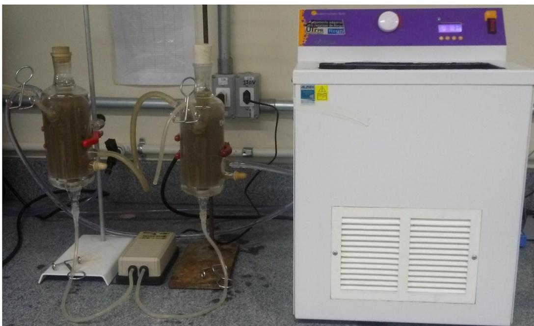
**Figura 14 - Sistema utilizado para o tratamento biológico.**
