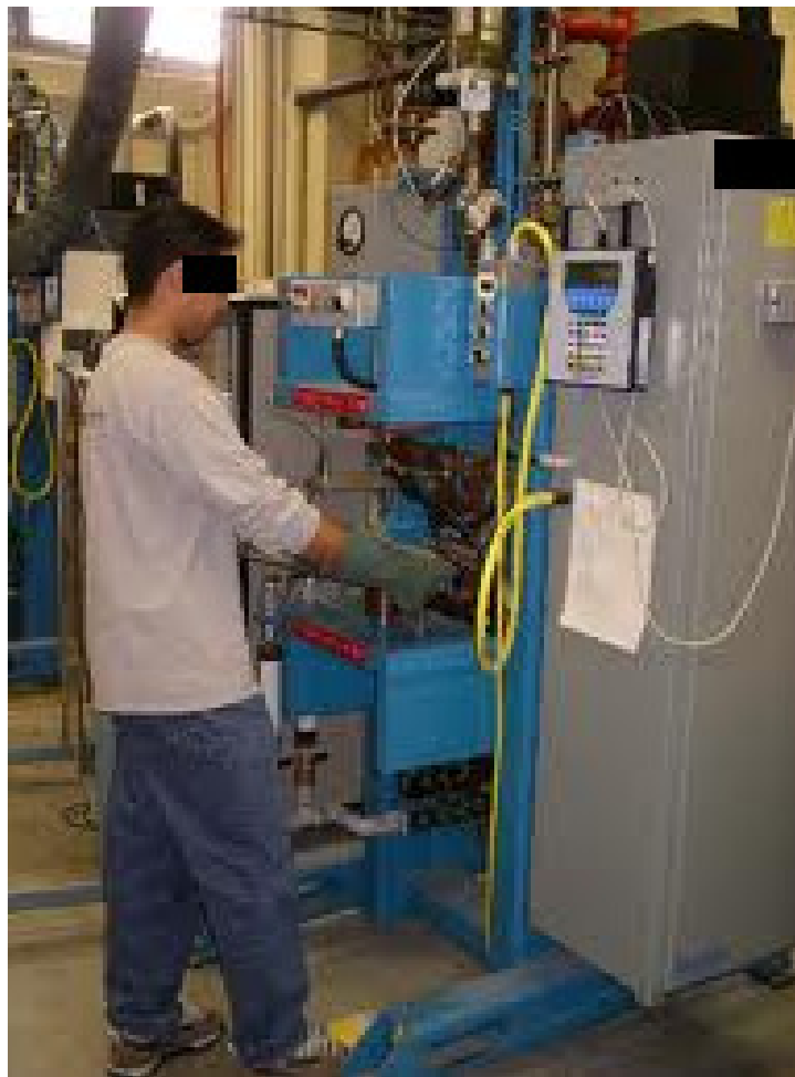
Figura 28 – Operador junto à máquina de solda a ponto. Fonte: pelo autor (2013)
