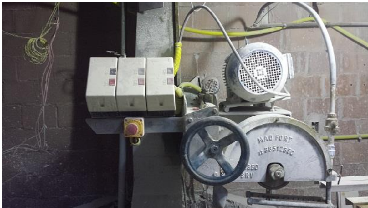
Figura 11 – Vista da chave blindada da serra mármore do empreendimento C Fonte: O autor (2015).
