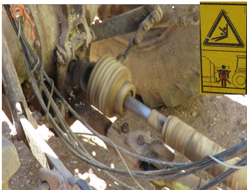
Figura 5: Tomada de potência do motor e sinalização de risco no local. Fonte: A autora (2018).
