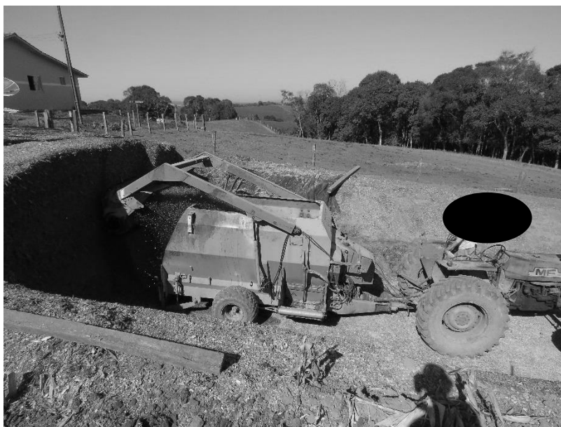
Figura 10: Processo de carregamento de silo mecanizado pela carreta misturadora. Fonte: A autora (2018).
