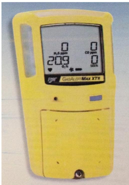
**Figura 12 – Medidor de gases BW Technologies**
