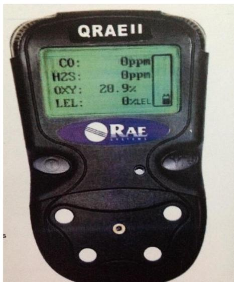
**Figura 11 – Modelo de detector de gases RAE systems**
