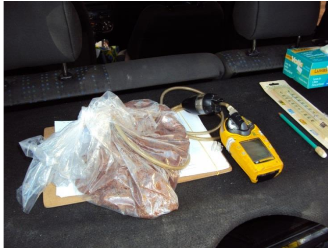
Figura 10 – Medição de COV em amostra de solo. Fonte: A autora, 2013
