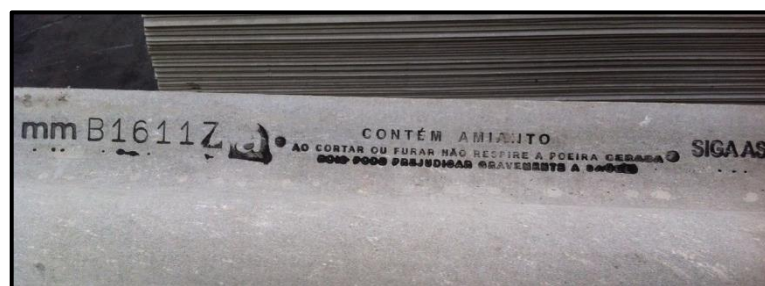
Figura 13 – Produto final com alerta sobre presença de amianto.
