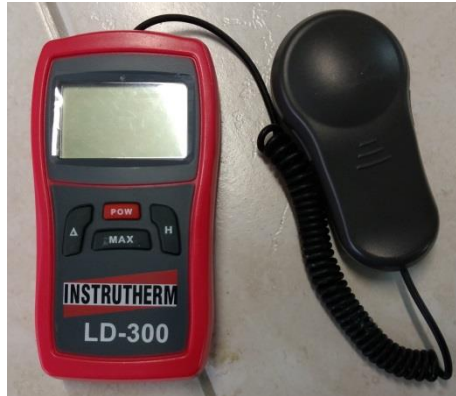
Figura 7 – Luxímetro utilizado para medição de iluminância. Fonte: O AUTOR
