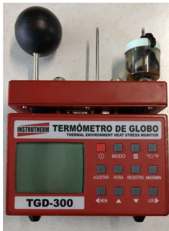
Figura 8 – Termômetro de globo utilizado para as medições de temperatura. Fonte: O AUTOR
