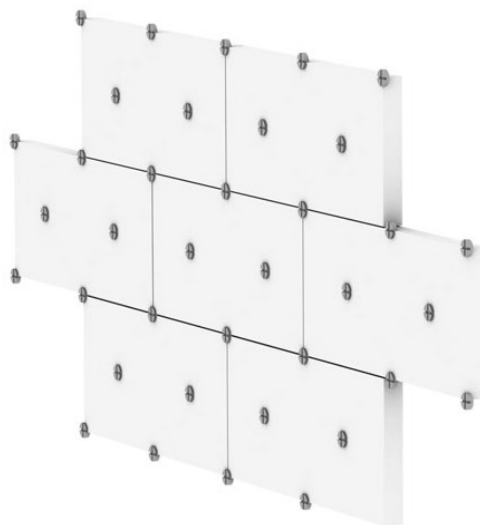
Figura 24 – Esquema de posicionamento dos pinos de fixação (MAPEI, 2014).
