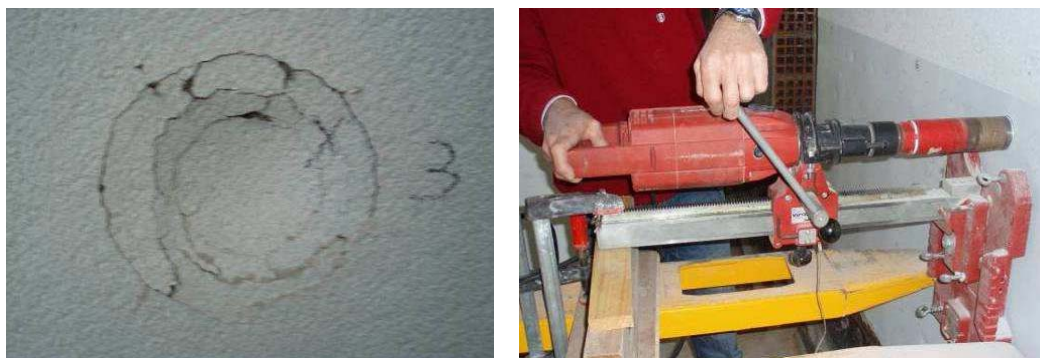
Figura 42 – Teste de resistência ao choque, realizado pelo Laboratório Nacional de Engenharia Civil de Portugal. (LNEC, 2010)
