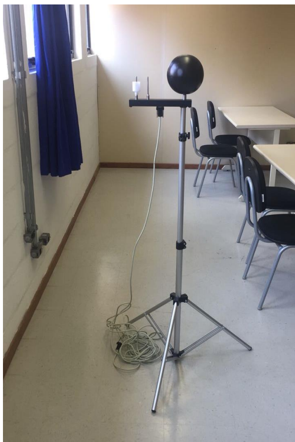
Figura 5 – Imagens Medidor de Termômetro de Globo
