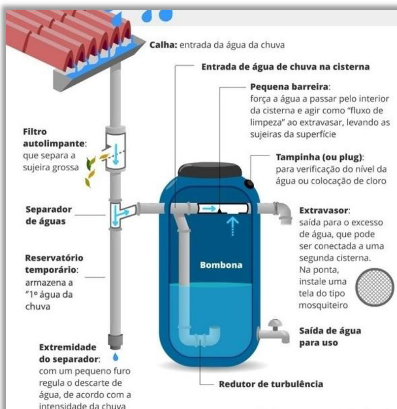
Figura 9 – Esquema do sistema de aproveitamento de água pluvial
