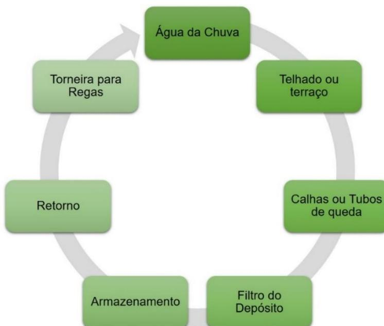
Figura 10 – Componentes básicos do sistema de aproveitamento de água de chuva
