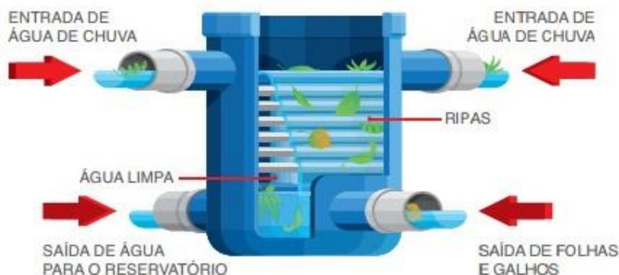
Figura 14 – Filtro para retenção de sólidos
