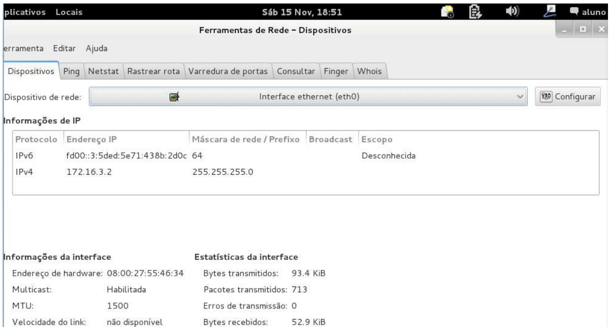
Figura 50 - Cliente Debian da LAN_C – Endereço IPv6 recebido via DHCPv6, interface gráfica. Fonte: Autoria Própria.
