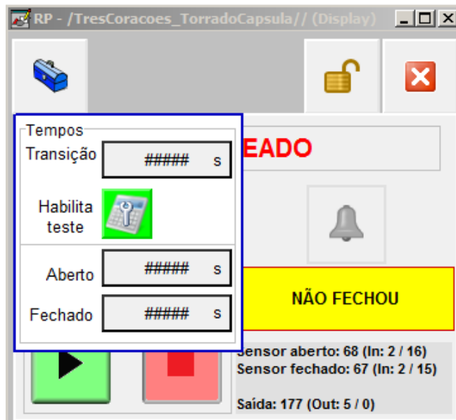
Figura 24: tela auxiliar para configurações extras do registro pneumático Fonte: autoria própria
