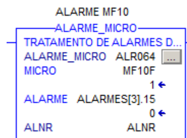
Figura 27: bloco de alarme por sensor fim de curso
