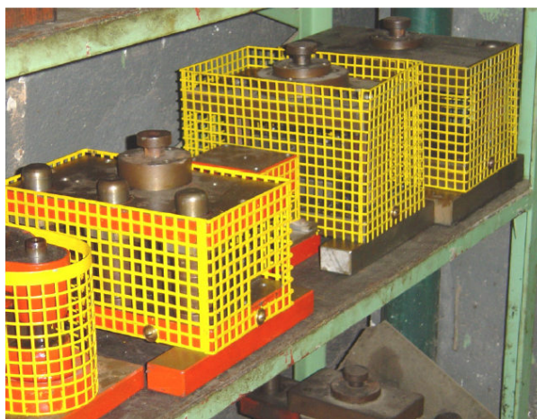
Figura 10 – Adaptação de proteção fixa em ferramentas Fonte: FIERGS (2006, p.73).
