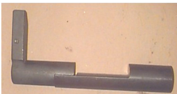
Figura 7 – Pino em forma de “L” e chaveta da PMEEC Fonte: FIERGS (2006, p.18).
