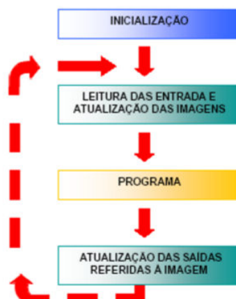
Figura 19 - Ciclo de processamento dos CLPs Fonte: Schionato (2007, p. 11).
