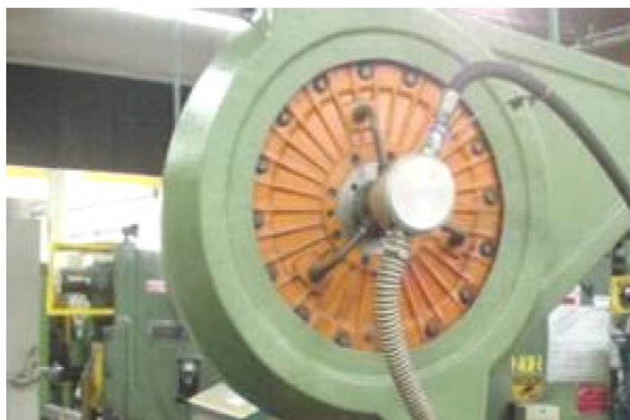
Figura 9 – Conjunto Freio/Embreagem de uma PMEFE Fonte: FIERGS (2006, p.27).
