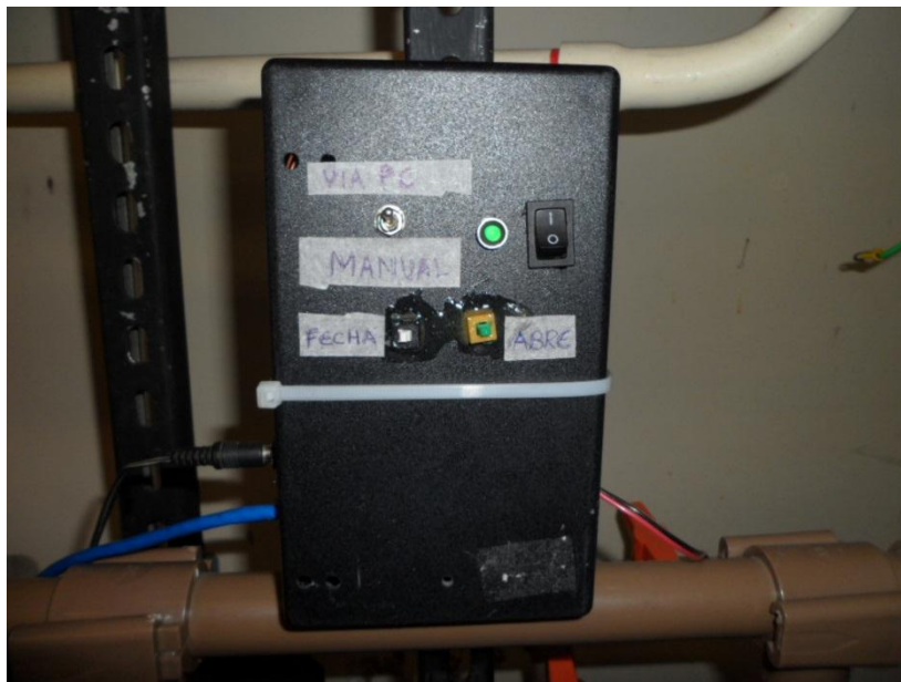
Figura 34: Protótipo do painel de controle da válvula.
