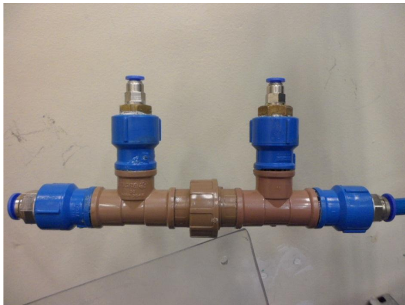
Figura 18: Tubo de placa de orifício
