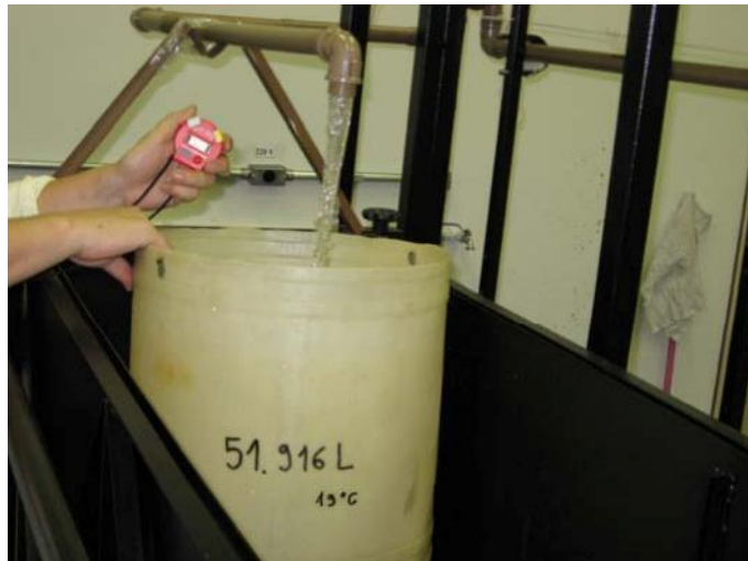
Figura 37: Verificação da calibração de vazão
