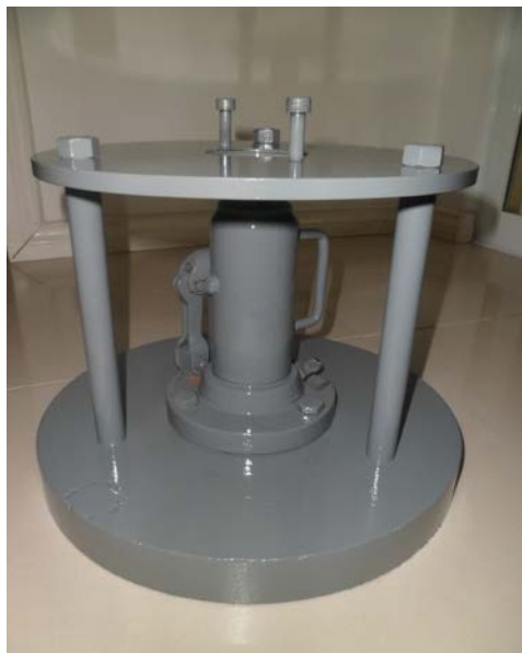
Figura 13 - Extratora para corpo de prova com dimensões reduzidas Fonte: Aatoria própria.
