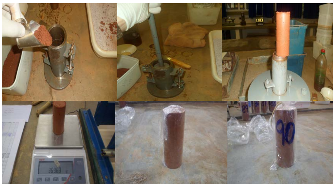
Figura 16 - Sequência de moldagem do CP reduzido executado em laboratório Fonte: Autoria própria.
