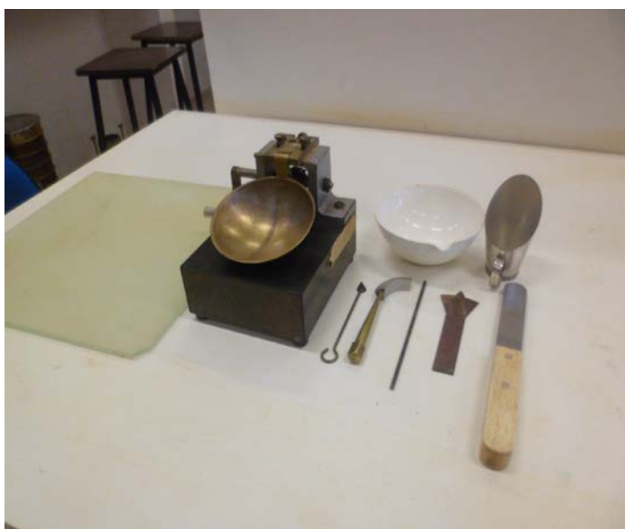
Figura 9 - Materiais utilizados no ensaio dos limites de Atterberg Fonte: Autoria própria.
