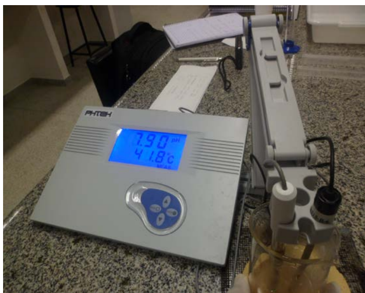
Figura 15 - Equipamento utilizado para o ensaio do pH Fonte: Autoria própria.
