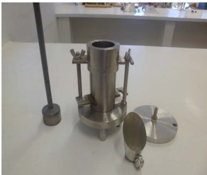
Figura 12 - Molde cilíndrico e soquete utilizado na confecção dos CPs
