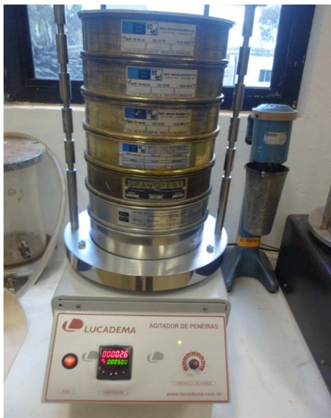
Figura 6 - Agitador de peneiras utilizado no ensaio Fonte: Autoria própria.
