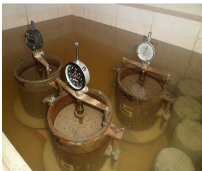
Figura 11 - Ensaio de CBR em tanque com relógios comparadores Fonte: Aatoria própria.
