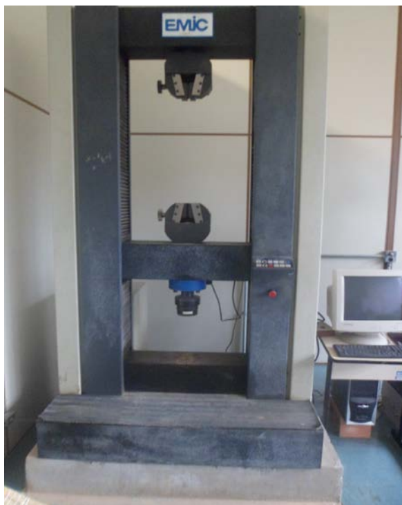
Figura 14 - Prensa universal utilizada nos ensaios de CBR e RCS Fonte: Aatoria própria.
