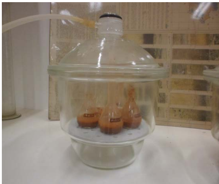
Figura 7 - Detalhe do ensaio para determinação da massa específica
