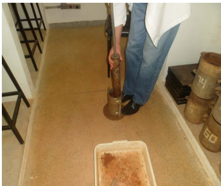
Figura 10 - Ensaio de compactação realizado conforme NBR 7182 (ABNT, 1986) Fonte: Autoria própria.
