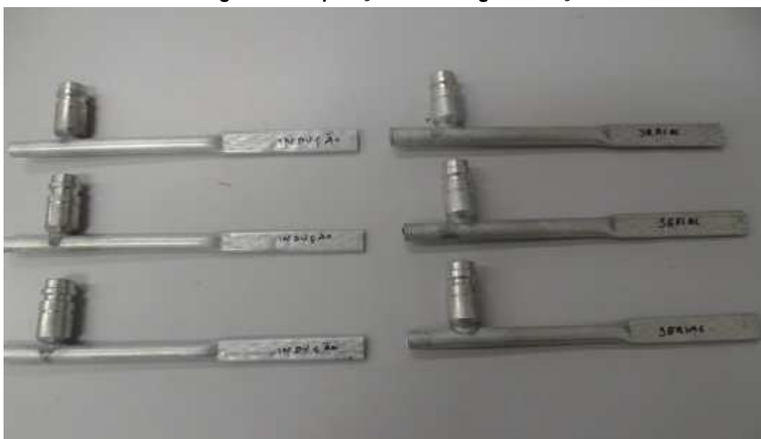
Fotografia 8 – Operação de brasagem indução
