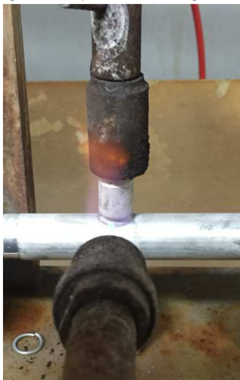
Fotografia 2 – Operação de brasagem manual
