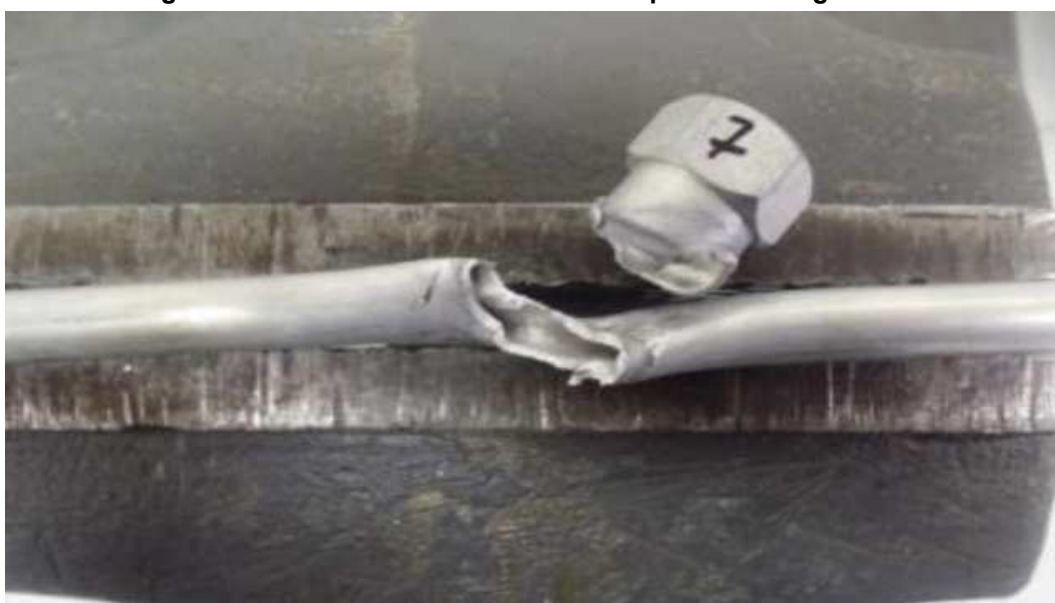
Fotografia 12 – Resultado de ensaio de torque em brasagem manual
