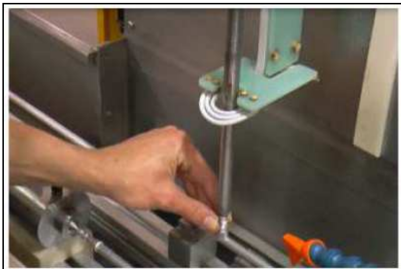
Fotografia 5 – Processo de brasagem indutivo
