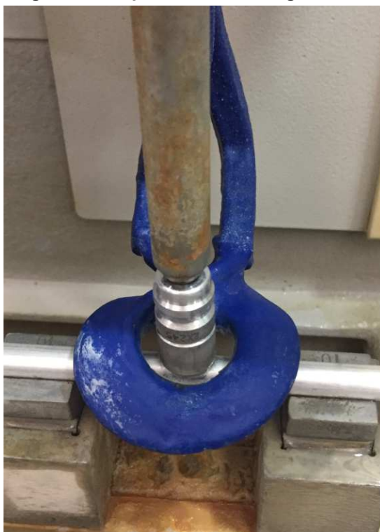
Fotografia 6 – Operação de brasagem indução
