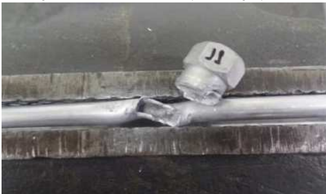
Fotografia 13 – Resultado de ensaio de torque em brasagem por indução
