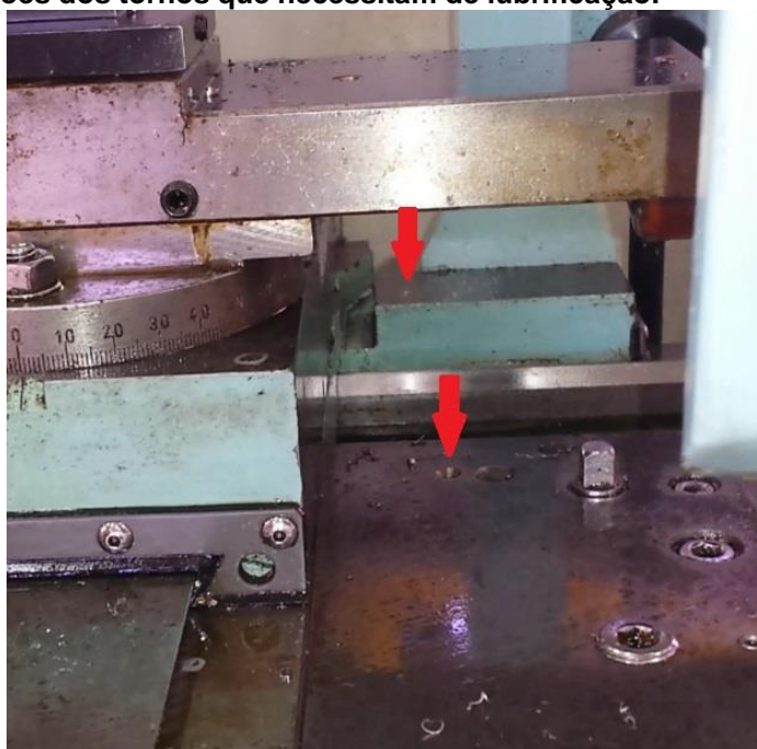
Figura 12: Mais regiões dos tornos que necessitam de lubrificação.
