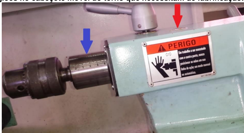
Figura 13: Regiões no cabeçote móvel do torno que necessitam de lubrificação.
