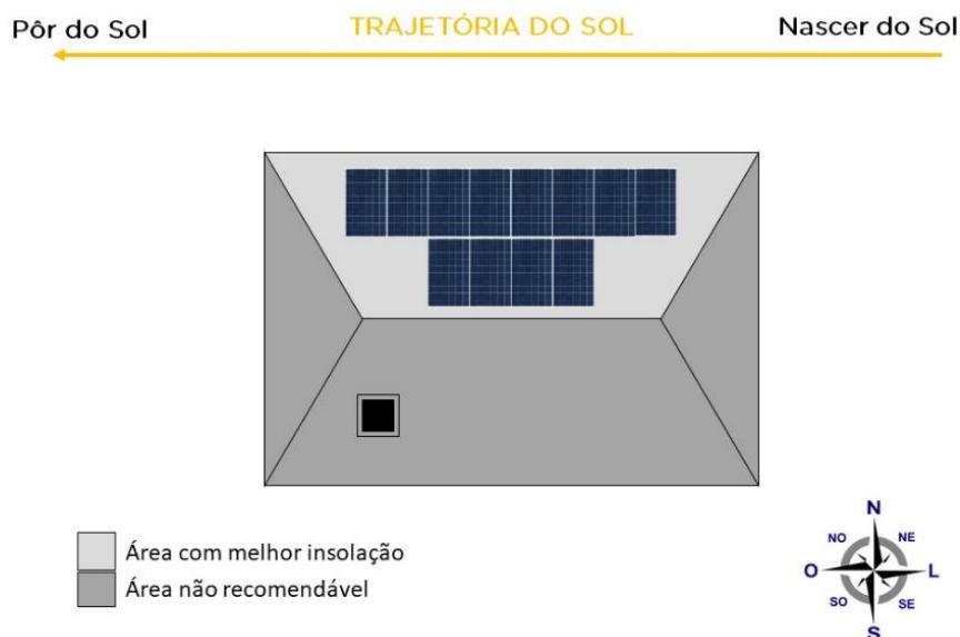
Figura 7: Posicionamento ideal em um telhado.
