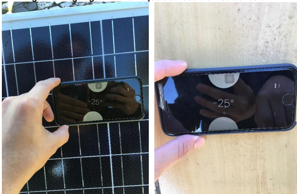
Figura 9: Regulagem de inclinação do módulo e medidor solar.
