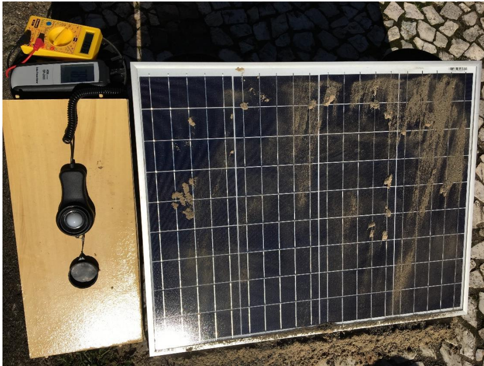
Figura 14: Módulo com detritos em estágio 2.
