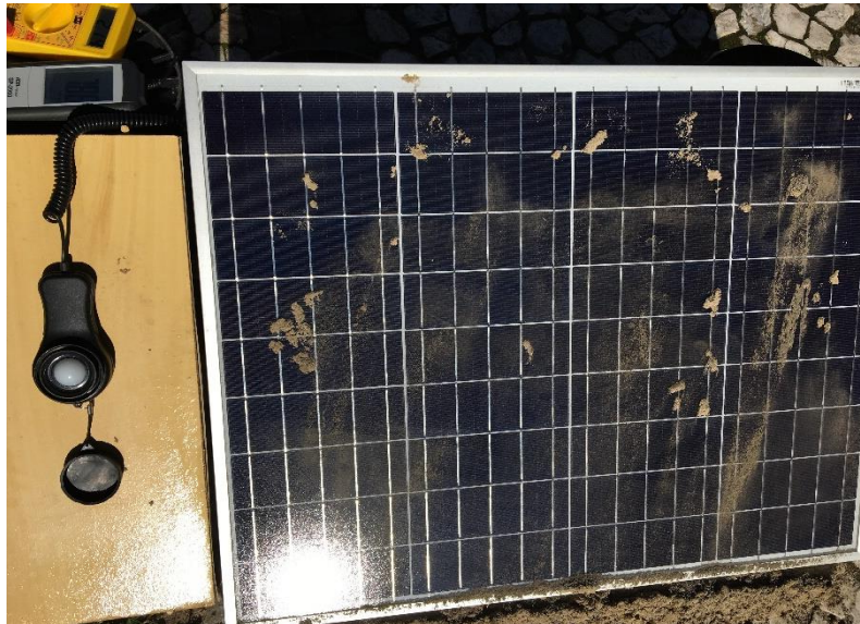
Figura 12: Módulo com detritos em estágio 1.
