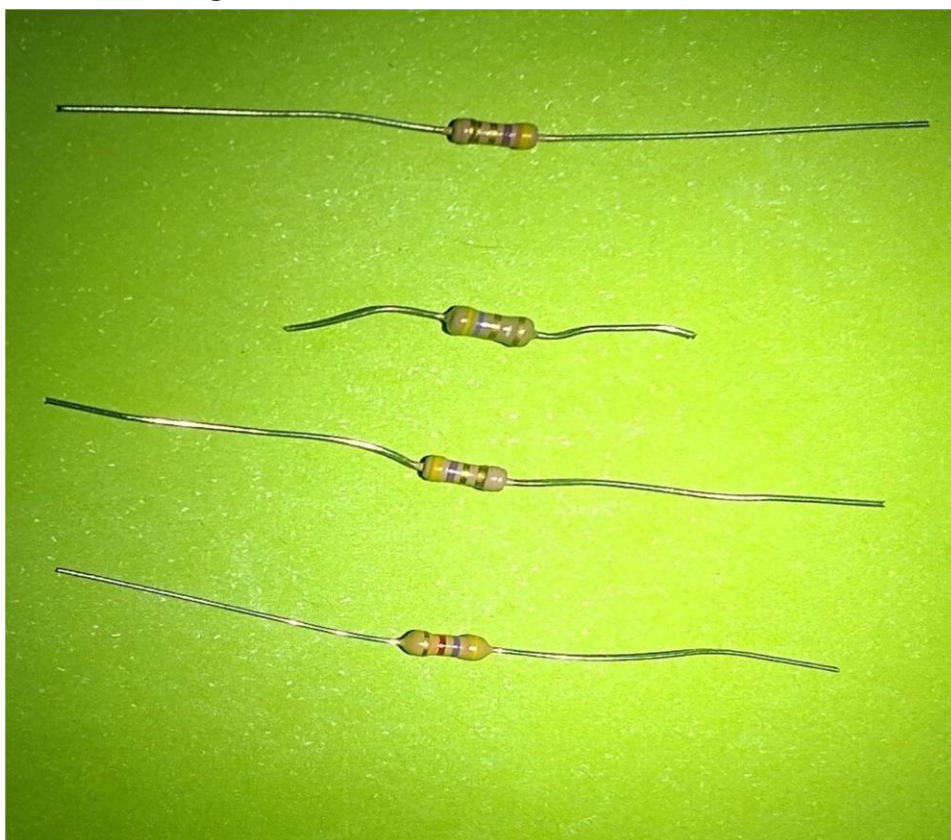
Figura 15 - Resistores 2.2K, 1.5K, 4.7K, 220ohm
