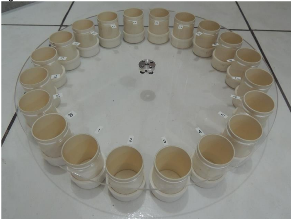
Figura 4 - Disco Confeccionado em acrílico 6 mm
