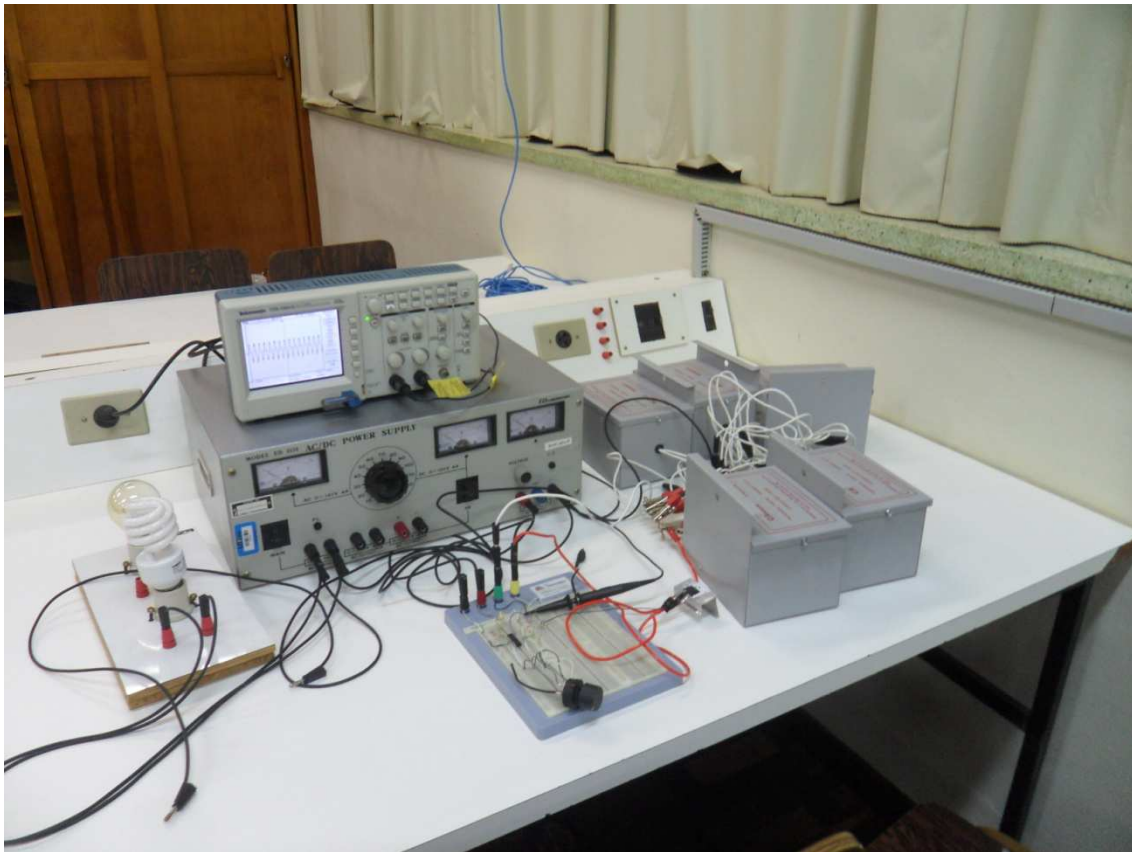
Figura 34– Bancada de teste para análise do flicker
