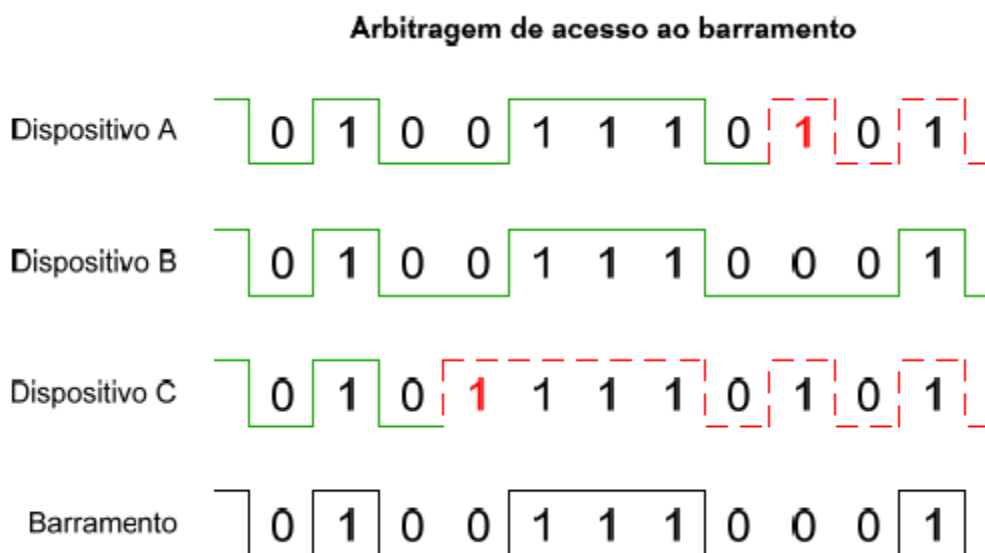
Figura 7: Arbitragem de acesso ao barramento. Fonte: [SOUZA, 2002].
