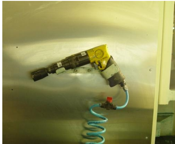
Figura 33: Parafusadeira pneumática próxima as portas. Fonte: Do Autor (2013).
