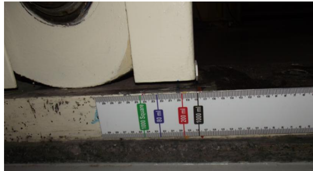
Figura 43: Grau de posicionamento da torres de desbobinamento. Fonte: Do Autor (2013).
