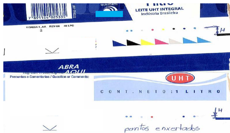
Figura 41: Falha na montagem dos clichês, duas imagens de embalagens. Fonte: Do Autor (2013).
