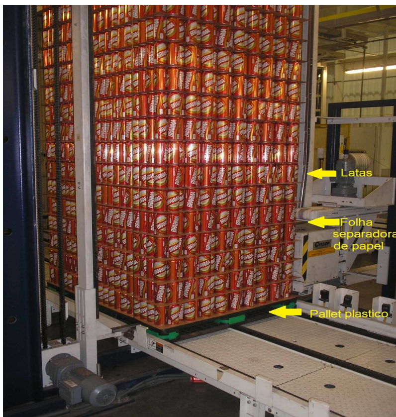
Fotografia 2 – Pallet pronto após a montagem do mesmo pela Paletizadora. Fonte: Autoria Própria
