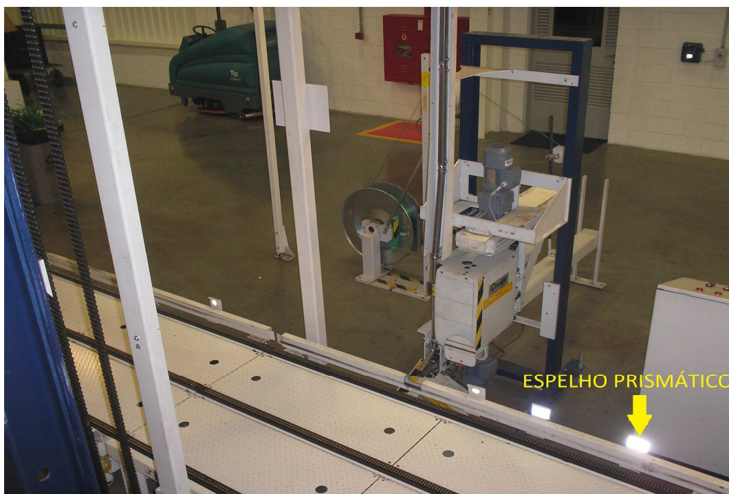
Fotografia 11 - Espelhos refletivos para os sensores. Fonte: Autoria Própria
