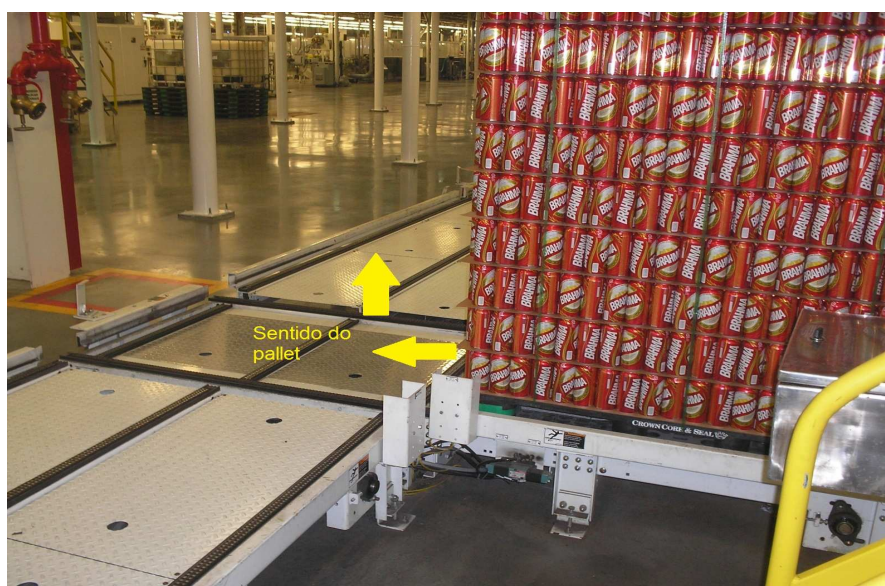
Fotografia 5 - Momento da transição de pallets entre esteiras. Fonte: Autoria Própria
