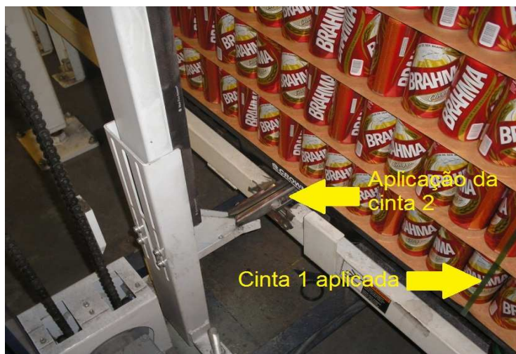
Fotografia 4 - Momento da passagem da cinta pela Cintadora. Fonte: Autoria Própria
