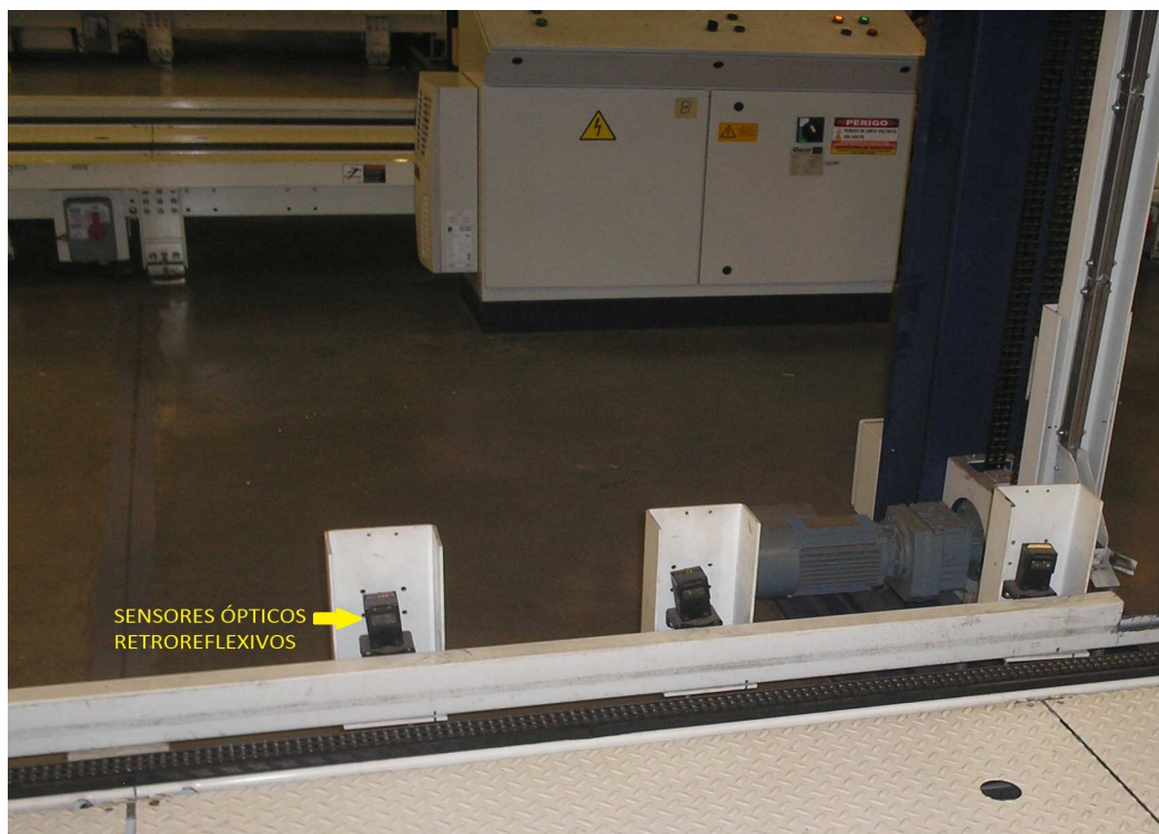
Fotografia 10 - Posicionamento dos sensores na Strapper (Cintadora) definindo os três pontos de parada do pallet para cintagem. Fonte: Autoria Própria
