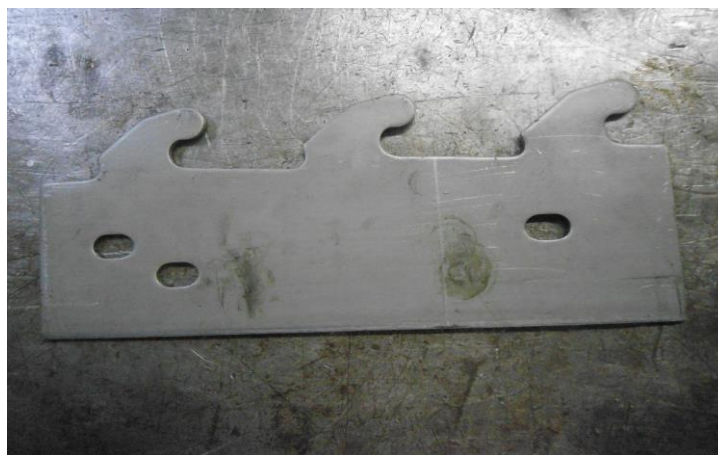
Figura 6: Garra após corte e estampo
