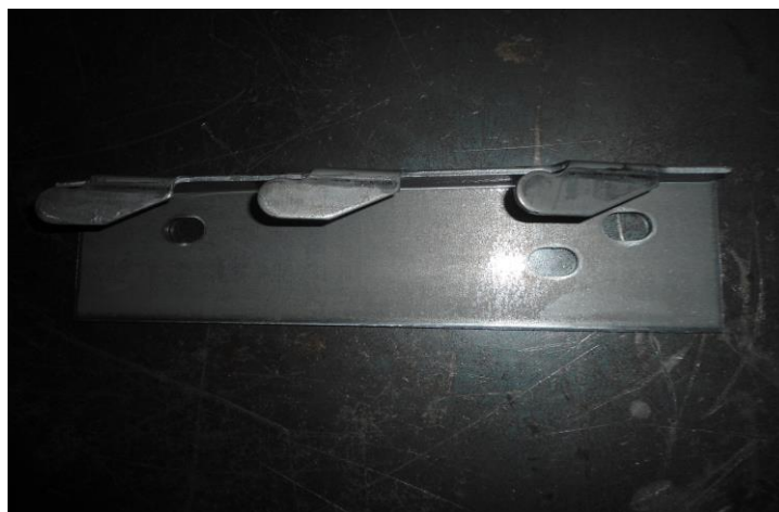
Figura 7: Garra após realização da dobra
