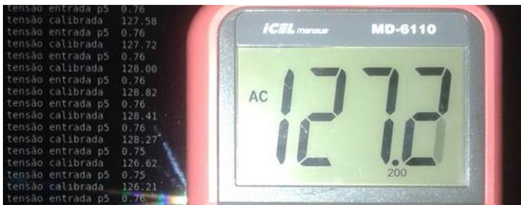
Figura 12: Tensão da rede elétrica apresentada no voltímetro e tensão calibrada apresentada no terminal do Linux. Fonte: Autoria própria.
