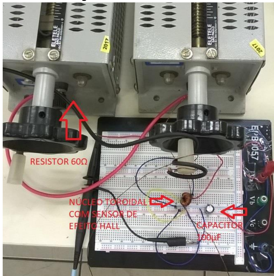
Figura 8 - Circuito físico final.
