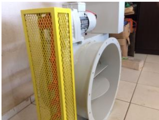
Figura 5. Válvula do conjunto mecânico Fonte: Autoria própria
