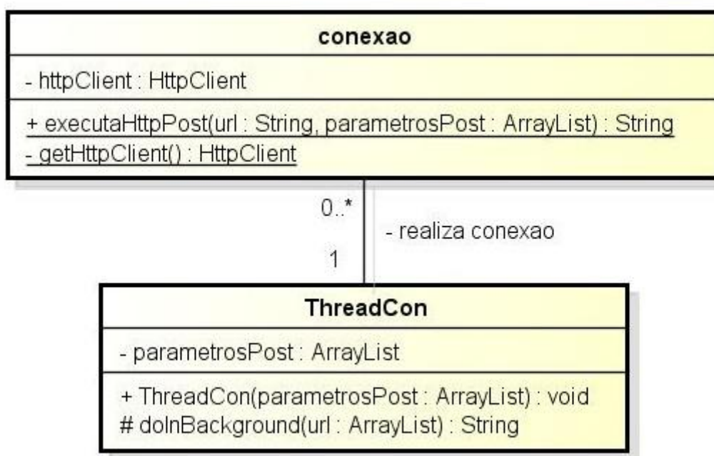
Figura 8 – Diagrama de classe (classes ThreadCon e conexao) Fonte: Autoria própria
