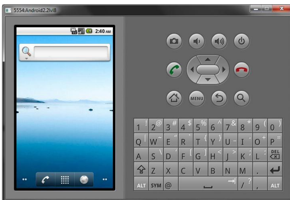
Figura 3 - AVD em execução.
