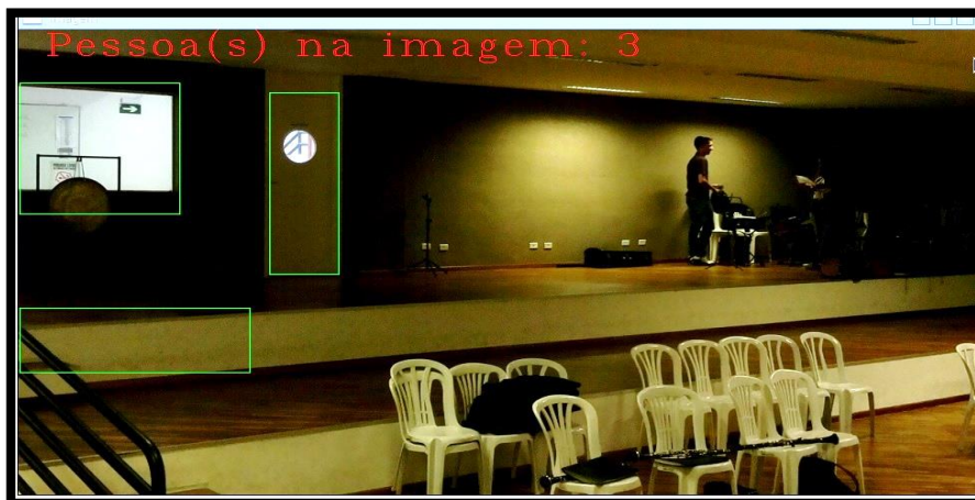
Figura 35 – Detecção falha por alteração na iluminação do ambiente Fonte: Autoria Própria
