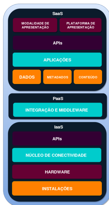
Figura 4 – Infraestrutura da pilha *aaS Fonte: Adaptação de (BOJANOVA; SAMBA, 2011)
