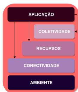
Figura 3 – Modelo de Arquitetura da Computação em Grade Fonte: Adaptação de (FOSTER; KESSELMAN; TUECKE, 2001)
