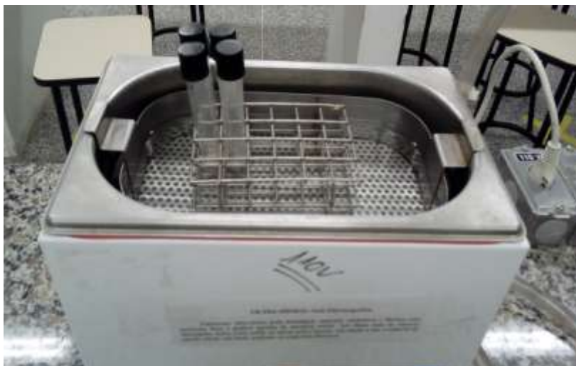
Fotografia 2 - Equipamento de Extração Assistido por Ultrassom do laboratório Análise de Alimentos da UTFPR Ponta Grossa
