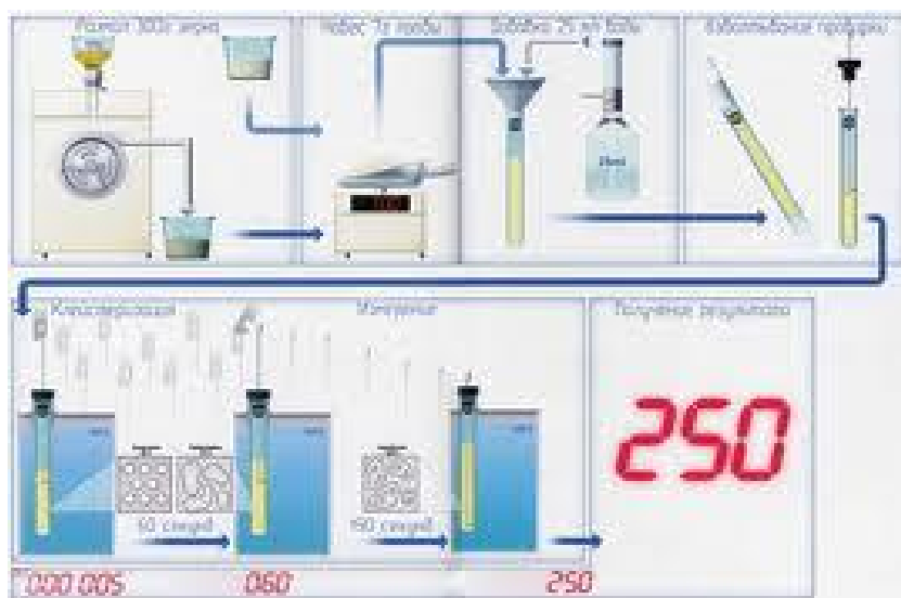
Figura 8. Funcionamento do aparelho de Falling Number.
