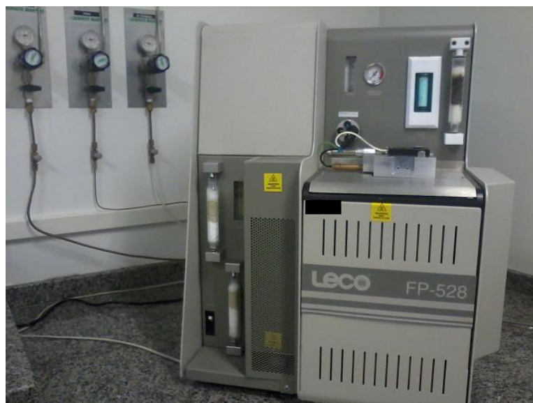
Figura 2 – Determinador de proteína por combustão (LECO FP-528)
