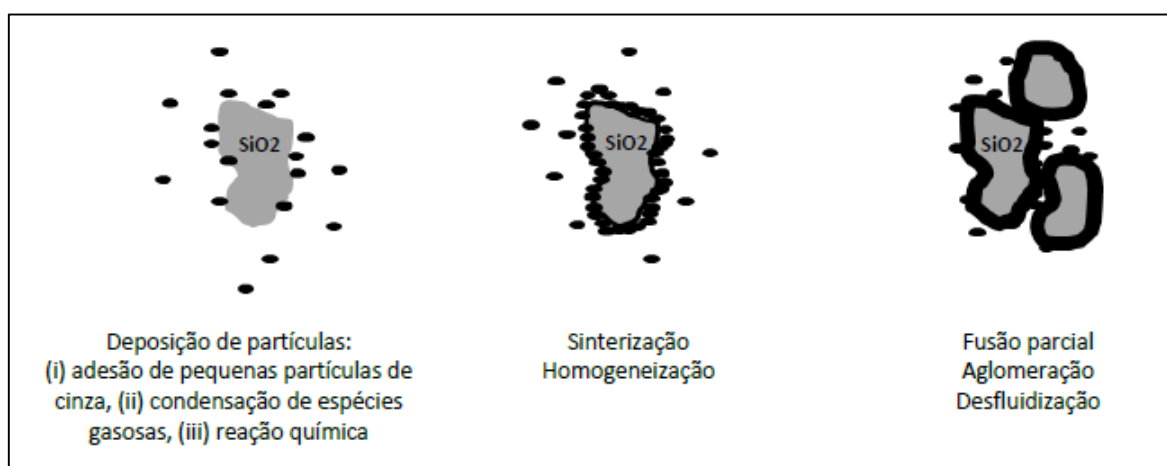
Figura 4 - Ilustração das etapas associadas à formação de aglomerados no leito.
