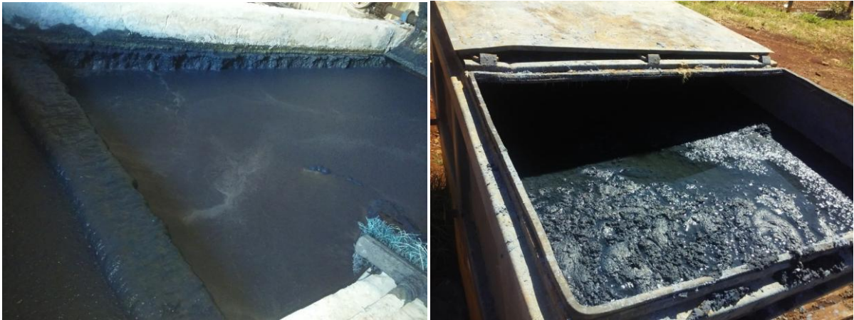
Figura 11 - Efluente industrial no processo de floculação (a) e o lodo gerado no tratamento do efluente (b)
