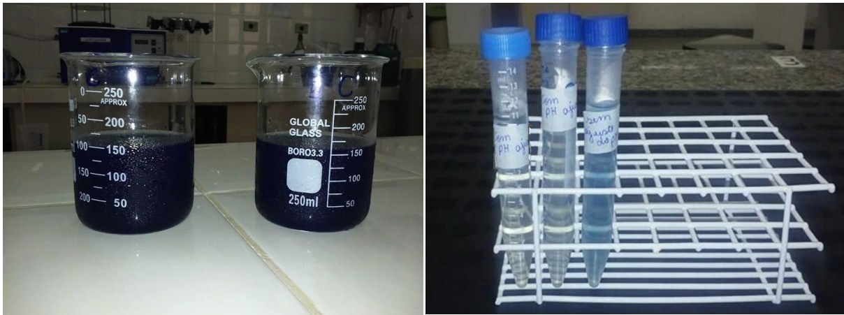
Figura 12 - Efluente industrial sem nenhum tratamento (a) e o efluente industrial após remoção da cor utilizando Celulose Bacteriana (b)
