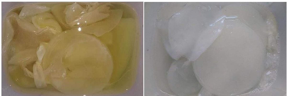
Figura 8 - Filme de Celulose Bacteriana após destruição do micro-organismo e lavagem (a) e filme de Celulose Bacteriana após 24 horas em uma solução de hipoclorito de sódio 30% (b)
