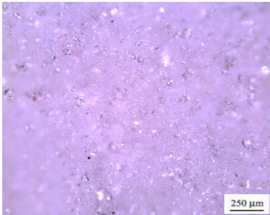
**Figura 19** - Amostra aumentada 200 vezes em microscópio ótico, corpo de prova com distribuição uniforme de partículas e sem sinais de cristalização na superfície.
