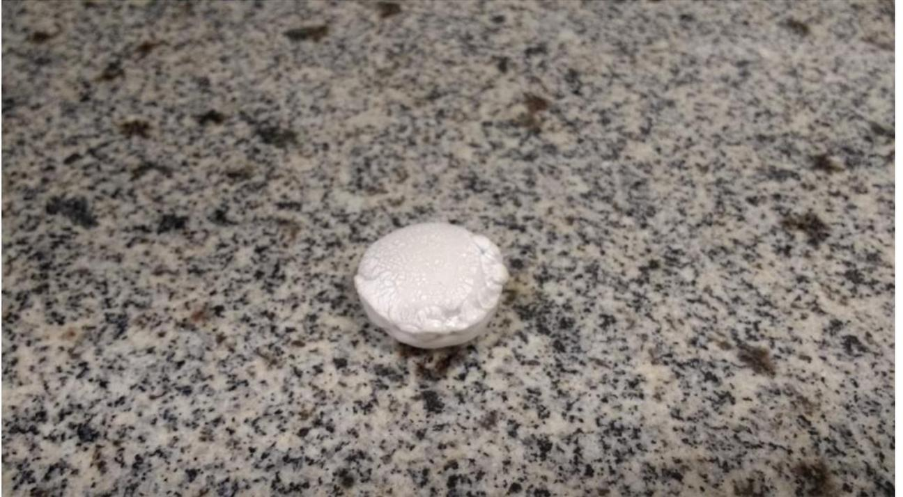
**Figura 17** - Amostra sinterizada a 700°C por 2 horas, apresenta sinais claros de vitrificação.
