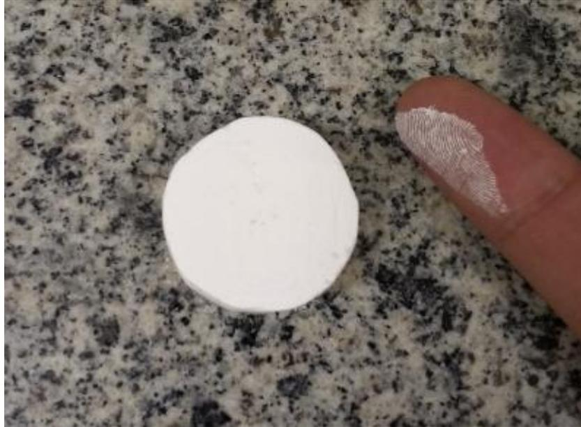
**Figura 16** - Membrana retirada do gesso, apresenta pouca resistência física, o pó se solta facilmente.
