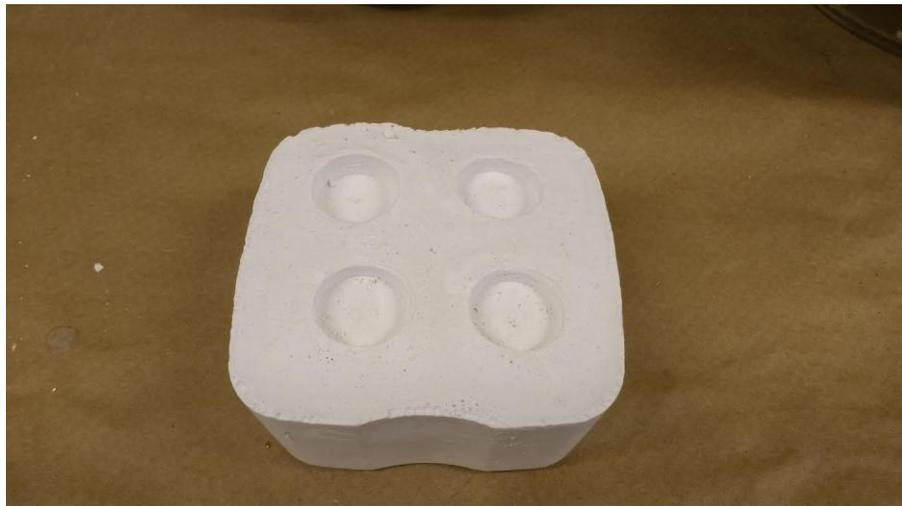
**Figura 15** - Molde de gesso, furações com 25mm de diâmetro e 15mm de profundidade
