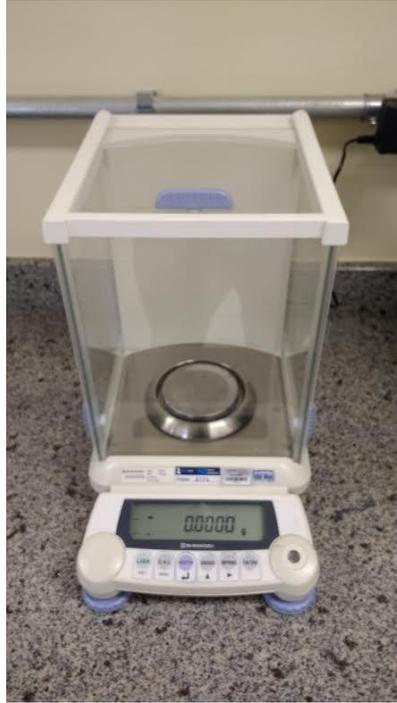
**Figura 12** - balança a precisão
