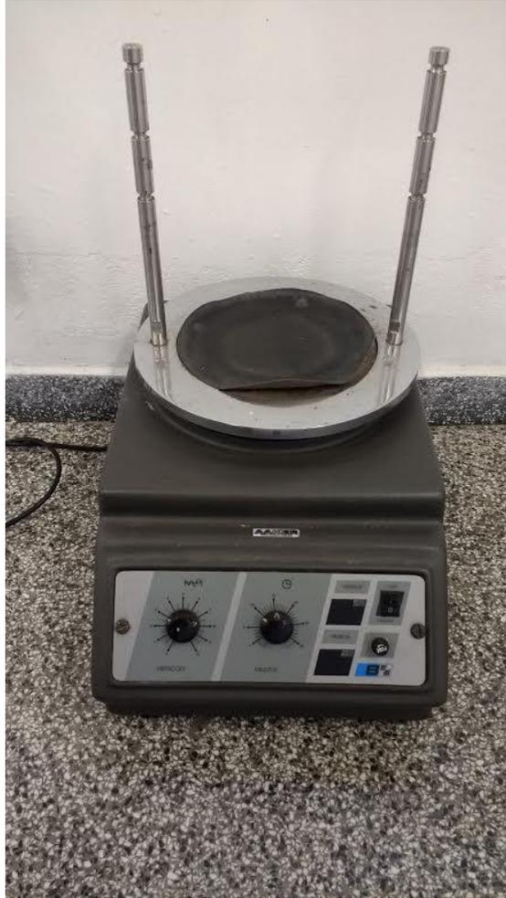
**Figura 11** - Mesa vibratória para peneiramento
