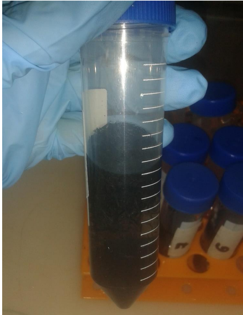
Figura 7: Teste para as amostras 6, 7 e 8: Cinza da casca de arroz em contato com água contaminada com gasolina.
