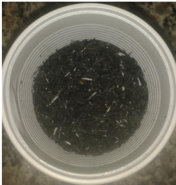
Figura 6: Cinza da casca de arroz mais significativa, retida na peneira de número 30.
