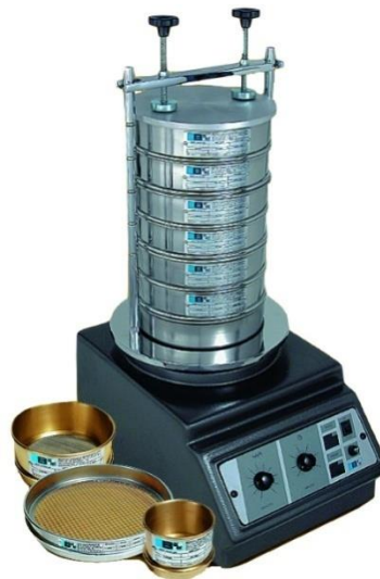
Figura 2 - Peneiras com agitador magnético utilizadas para análise granulométrica.
