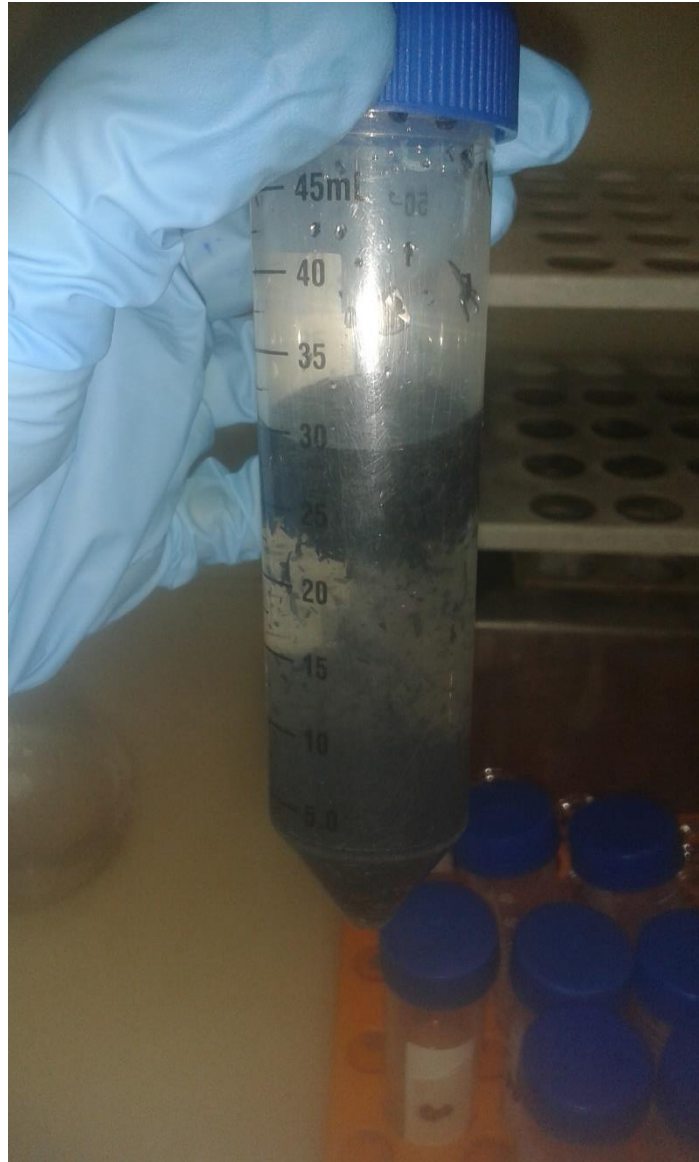
Figura 4 – Cinza da casca de arroz em contato com a amostra de água contaminada com gasolina.
