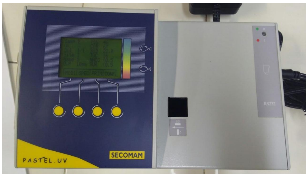
Figura 14 - Espectrofotômetro Pastel UV SECOMAM® Fonte: A autoria própria (2017)
