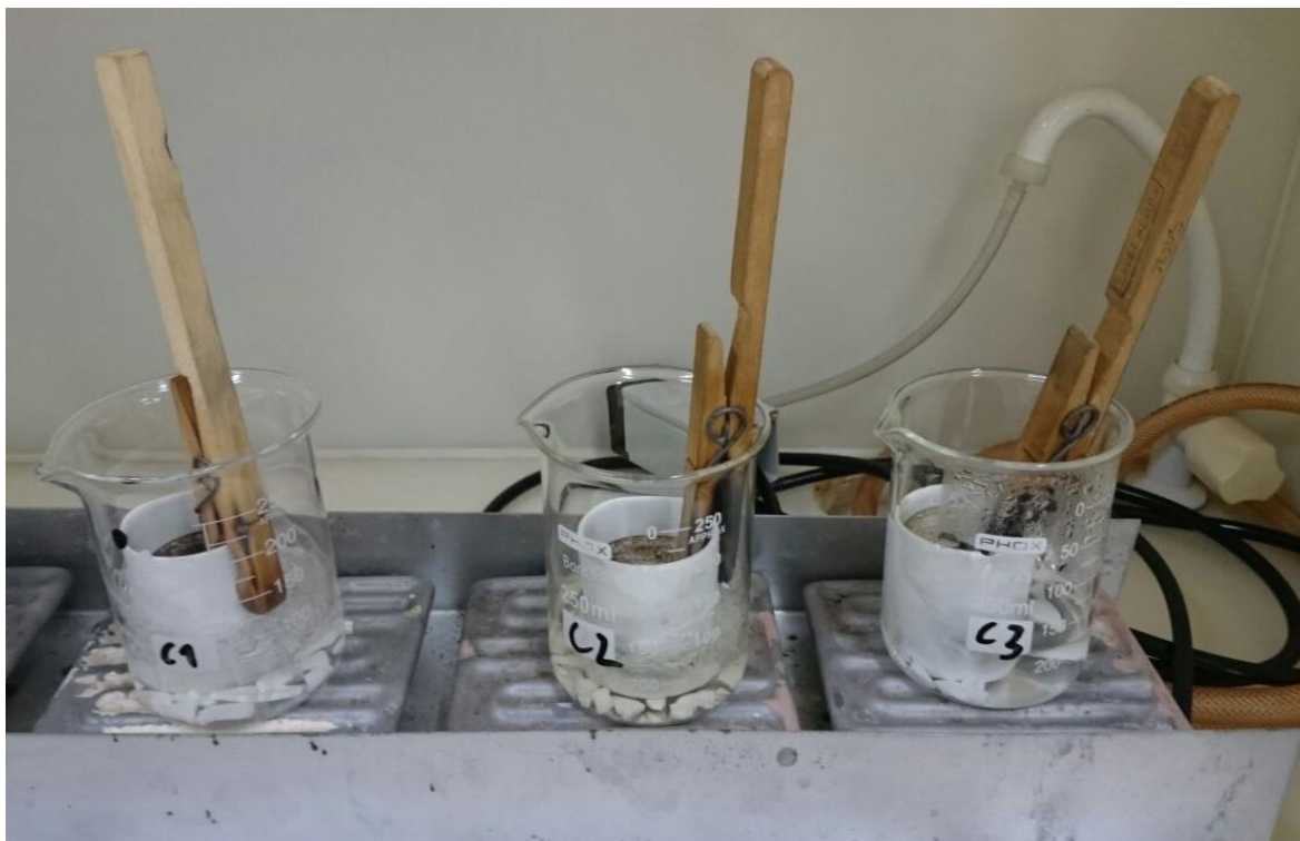
Figura 12 - Aquecimento das amostras em banho maria durante análise de sólidos totais, sólidos fixos e sólidos voláteis Fonte: A autoria própria (2017)
