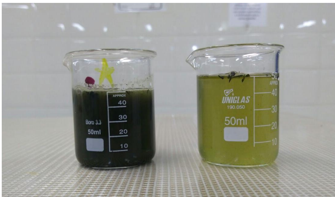
Figura 18 - Biomassa e biofertilizante (da esquerda para direita) oriundos do sistema de produção de biogás e tratamento de efluentes Fonte: Autoria própria (2017)
