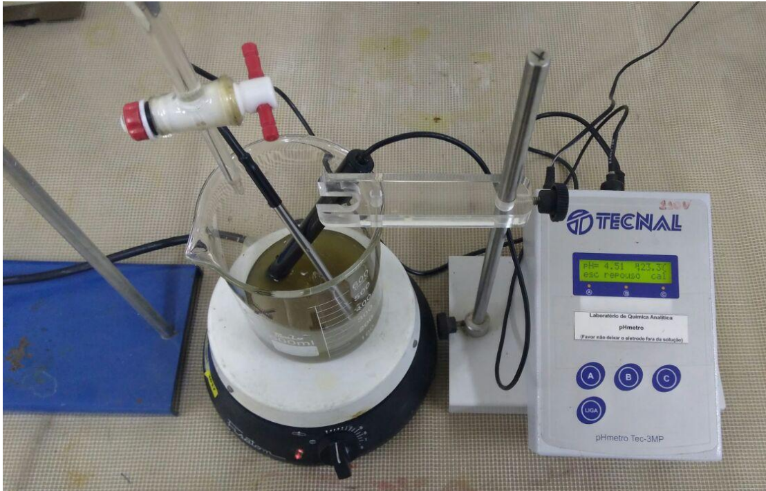
Figura 13 - Procedimento utilizado na análise de alcalinidade total Fonte: A autoria própria (2017)
