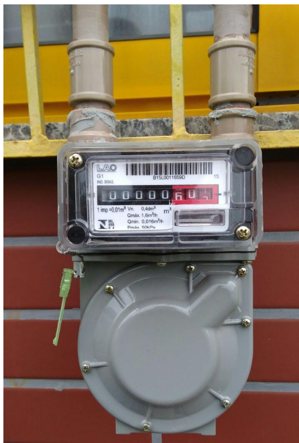
Figura 16 - Rotâmetro utilizado para medição de vazão do biogás do sistema experimental Fonte: Autoria Própria (2017)
