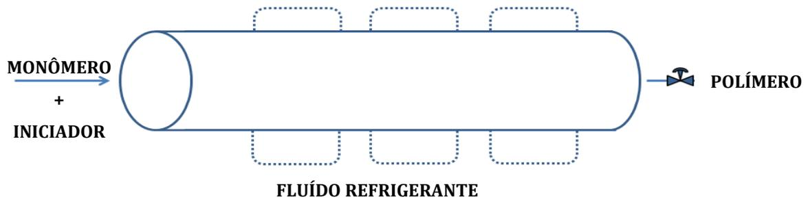
**Figura 3 – Esquema de um reator tubular para produção de PEBD**
