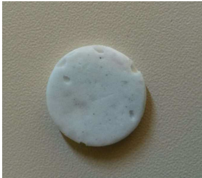
Figura 26 – Amostra com desprendimento de massa.
