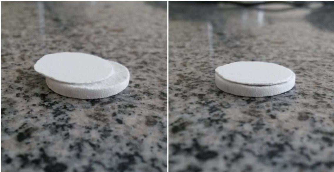
Figura 23 – Amostra descartada devido à delaminação extrema.
